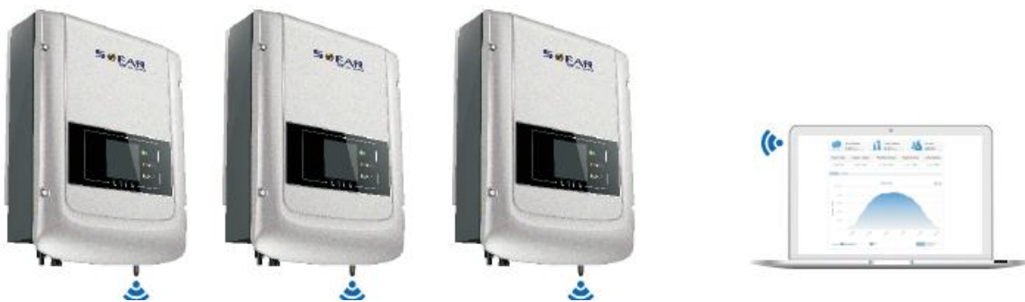
Figura 40 - Connessione di più inverter con wifi
