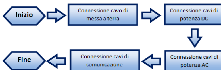
Figura 13 – Passaggi per la connessione dei cavi
